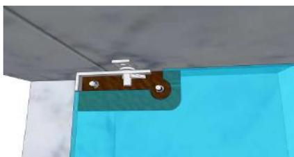
Na fixação da dobradiça 1101S vamos então colocar o calço de apoio.
